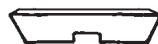
50921 36 x 70 mm x 60 cm met inkeping (7 cm) 50923 45 x 90 mm x 60 cm met inkeping (9 cm)
