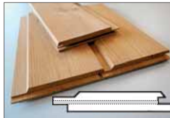
TWPL19140 ThermoWood planchette met kopse tand/groef 19 x 140 mm geschaafd. Nuttige breedte 13 cm
